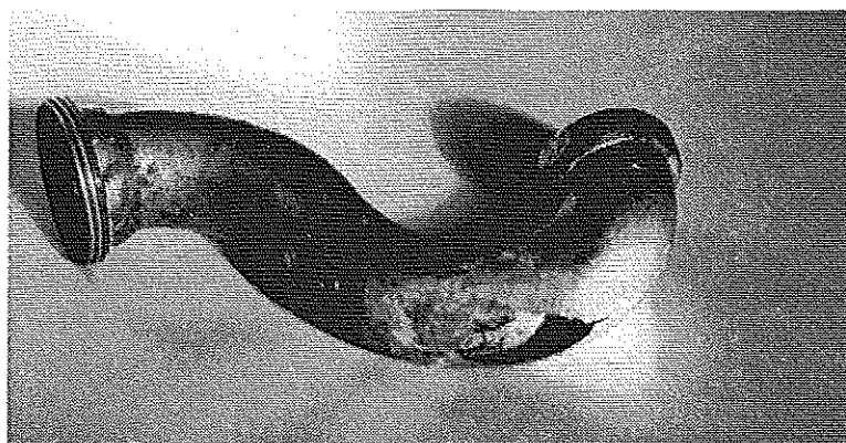
Corrosion interne et externe d'un siphon d'évier de cuisine
