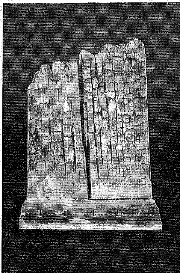
Décomposition en cubes du bois dégradé par la Mérule
