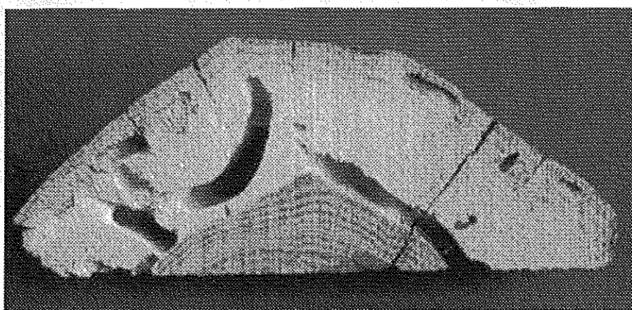
Fig. 3 : Aspect des dégâts d' Hespérophanes dans de l'aubier de chêne (CTBA).
