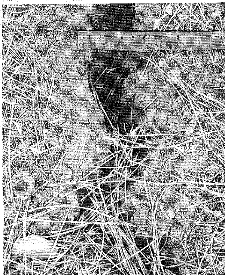
Photo 3 : Mesure de la largeur de fissure en surface (détail). © J. Putatti
