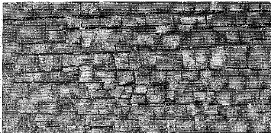
Fig. 10 : Aspect du bois dégradé par la mérule : pourriture cubique (CTBA).
