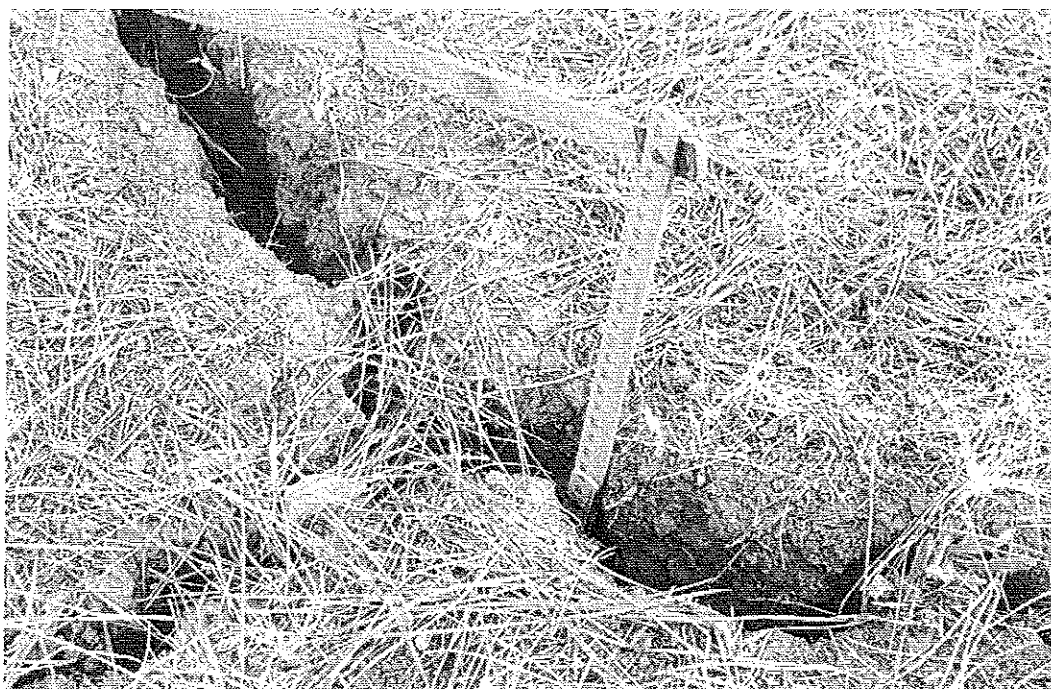
Photo 4 : Mesure de la profondeur (approchée) d'une fissure. © J. Putatti
