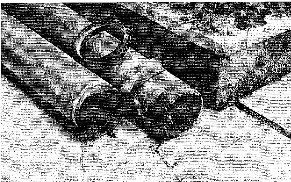
Après dépose de certaines canalisations, constater l'importance des dépôts
